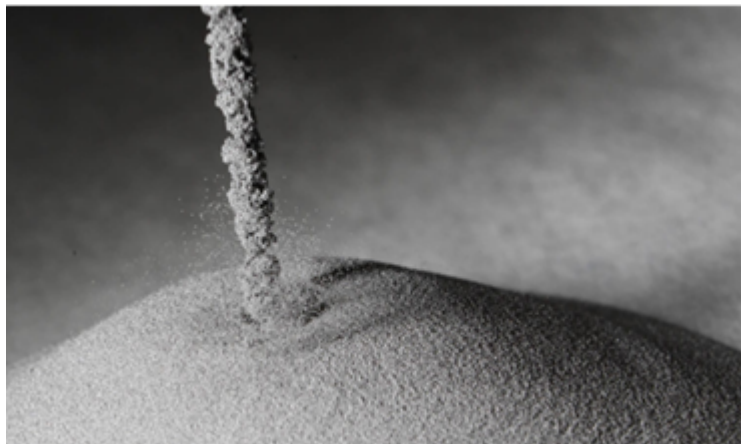
Image 1 : Poudre de titane métallique de PyroGenèse produite par son système d'atomisation au plasma NexGen MC .
