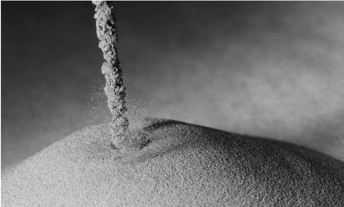
Image : la poudre métallique de titane de PyroGenèse, telle que produite par son système d'atomisation par plasma NexGen MC .
