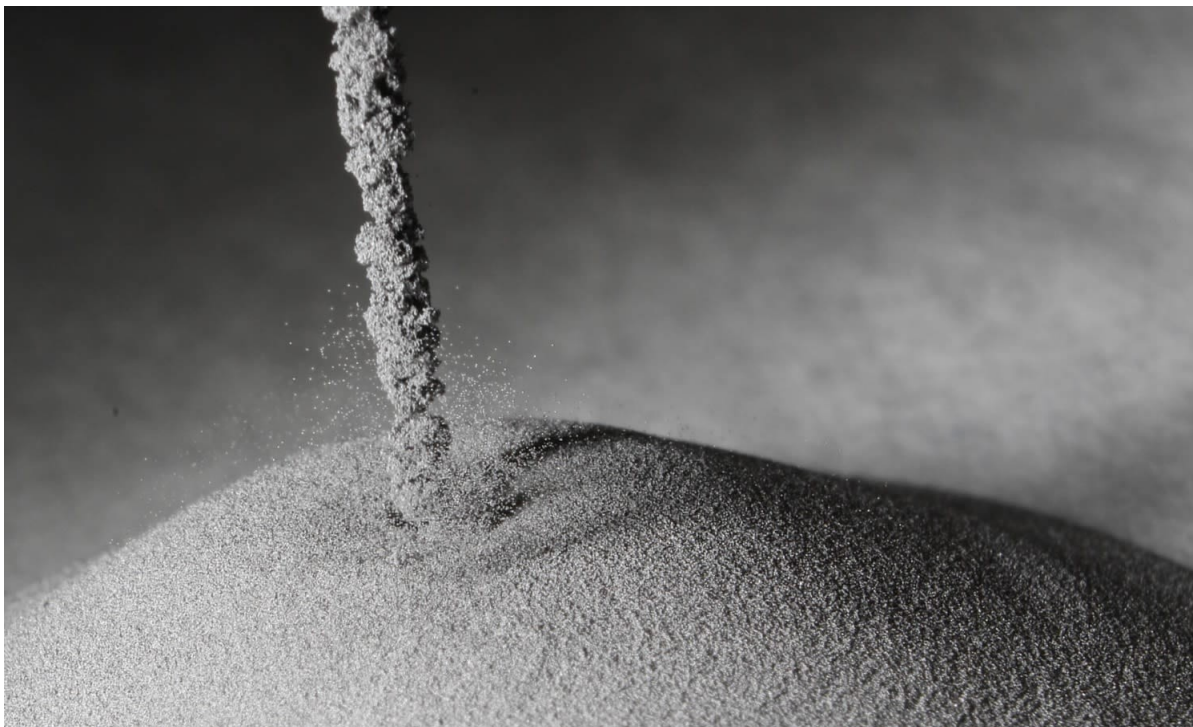
Image : Poudre métallique de titane de PyroGenèse produite par son système d'atomisation au plasma NexGen MC .
