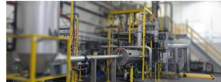
Photo de l'usine pilote du réacteur de réduction du quartz (RRQ) PUREVAP™ de troisième génération de PyroGenèse
