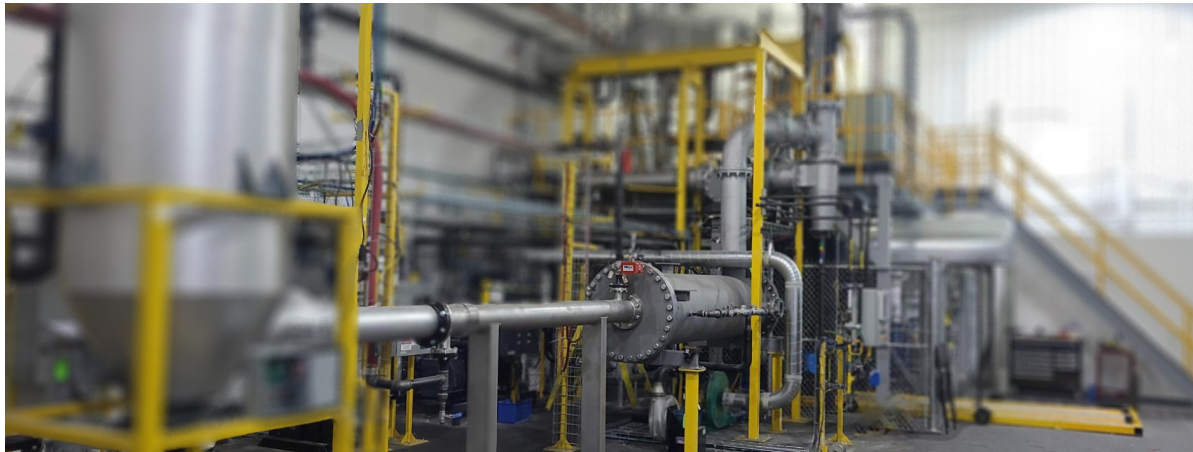
Figure 1- Photo de l'usine pilote du réacteur de réduction du quartz (RRQ) PUREVAP™ de troisième génération de PyroGenèse
