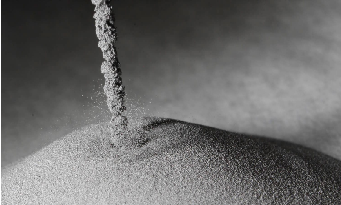
Image : Poudre de titane métallique de PyroGenèse telle que produite par son système d'atomisation plasma NexGen MC
