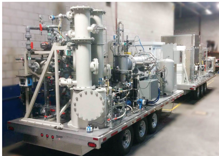
Image : une version mobile du système PACWADS de PyroGenèse destinée à la destruction d'armes chimiques.
