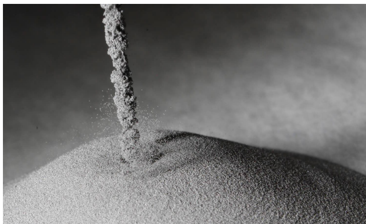
Image : poudre de titane métallique de PyroGenèse produite par son système d'atomisation au plasma NexGen MC .
