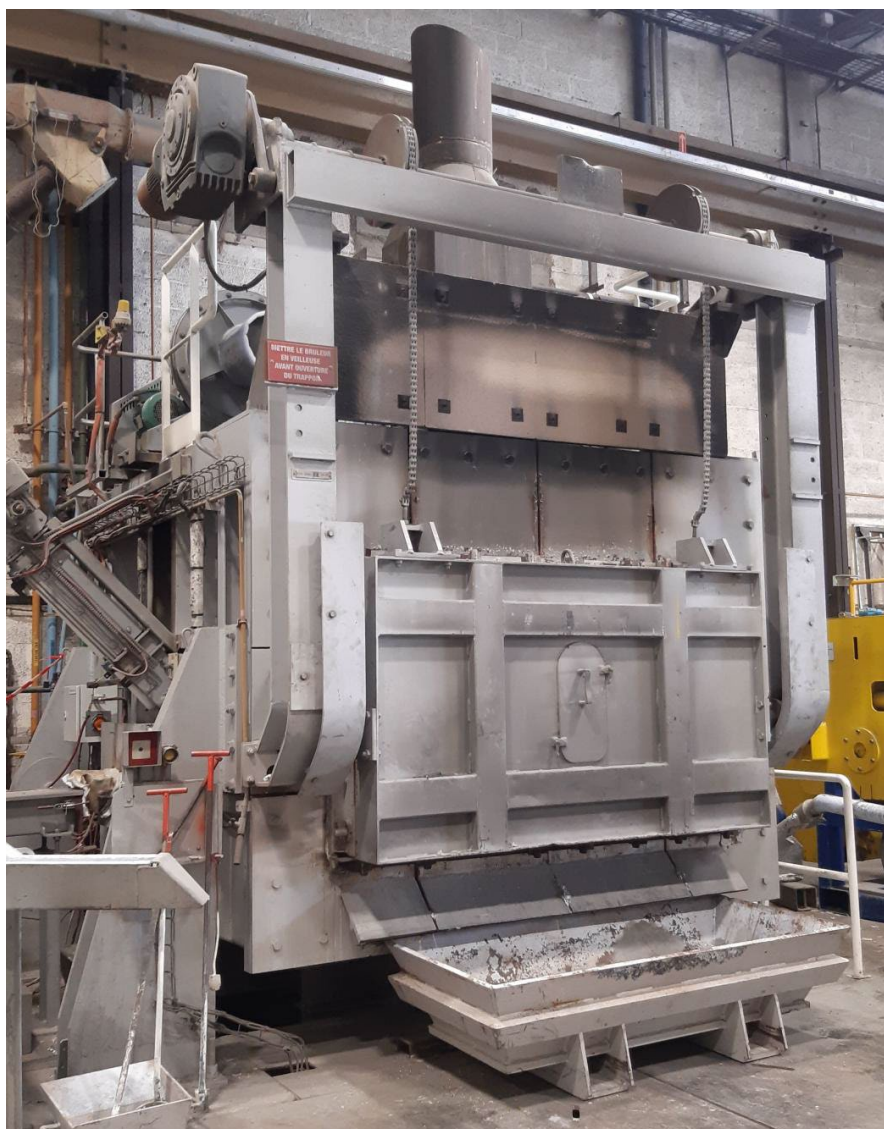
Image : four de fusion à réverbère utilisé dans l'une des installations d'aluminium de Constellium. Photo gracieusement fournie par Constellium.
